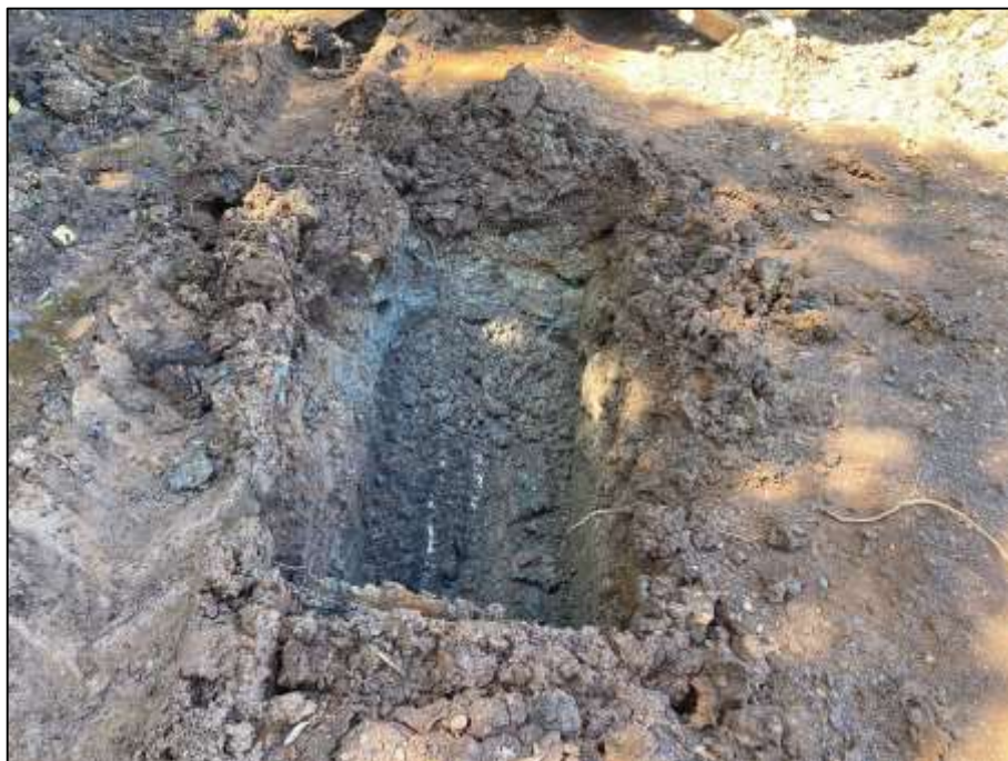
Figura 05 – Vista da rocha sã impenetrável e perfil do solo. Fonte: registrado pelo autor
